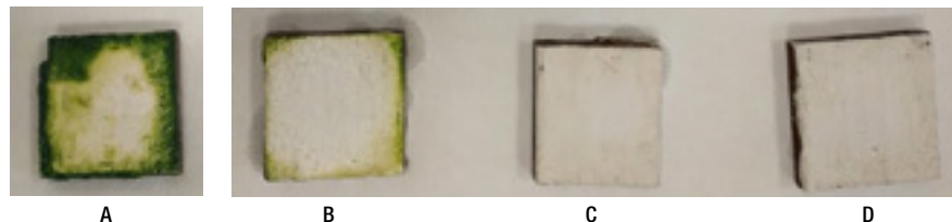
Abb. 4 // Ergebnisse der Laborprüfung gemäß EN 15458 der Beständigkeit gegen Algen: A – ohne Additiv auf Tonbasis, B – 67 g Additiv pro kg, C – 133 g Additiv pro kg, D – 266 g Additiv pro kg.
